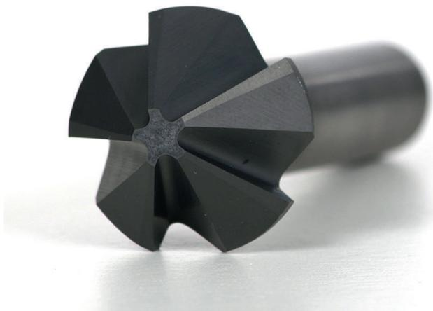
Kegelsenker mit angepasster CCDia-Aero-Speed-Beschichtung, der standzeitmaximiert glatte Oberflächen beim Senken in CFK oder GFK erzeugt
